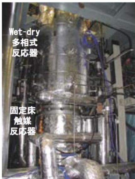
Fig.2.2.2 別海町エネルギー自立型実験プラントにおける水素添加反応器の外観<sup>(19)</sup>
