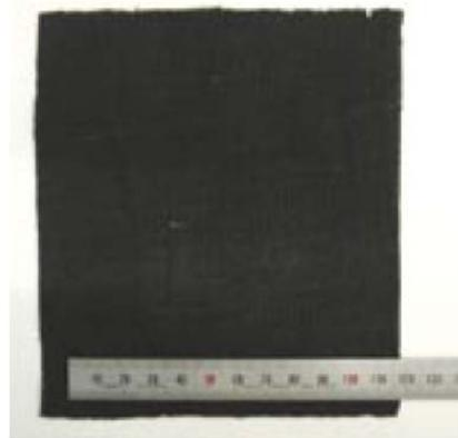
Fig.2.2.3 別海町エネルギー自立型実験プラントにおけるトルエン水素化工程の10wt%Pt/活性炭繊維触媒<sup>(19)</sup>
