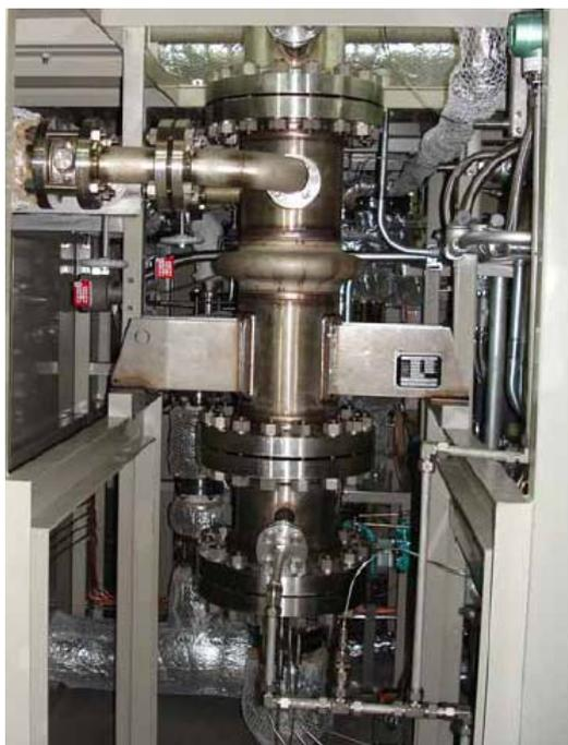
Fig.2.3.5 1Nm<sup>3</sup>/h 水素発生規模脱水素反応器(16)
