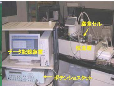
図2.2 電気化学試験に使用した試料と装置
