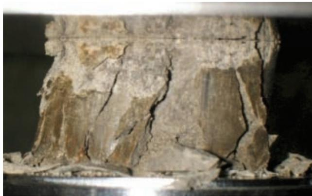
(b) 一軸圧縮試験中の様子
