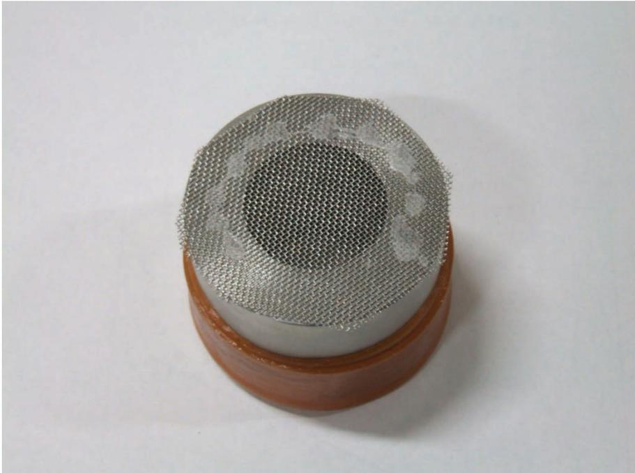
図 2-3 金網を貼った鋼製円筒の写真
