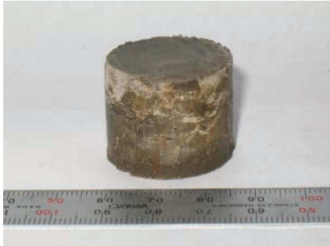
(a) 押し込み試験終了後の試験片の写真
