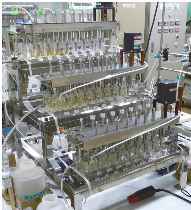
Fig. 4-16 第 2 回連続抽出試験における試験時のミキサセトラの様子
