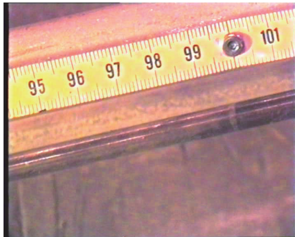
図 2.2-4 照射済み金属燃料ピンの外観 Pin#1: U-19Pu-10Zr, 燃焼度~2.5at.%. [2.2-10]
