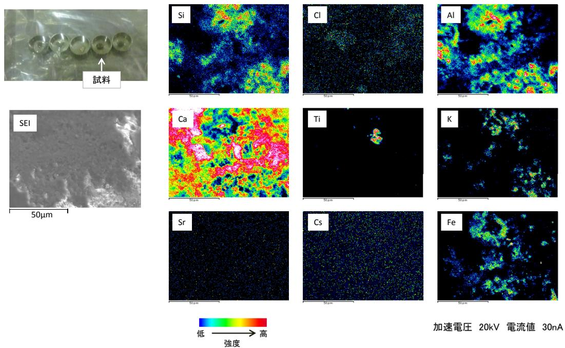
図 92 元素分析結果 (1号機2階⑩床ネル布試料、コンクリート片)
