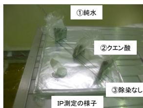
図 149 浸漬除染の試験手順
