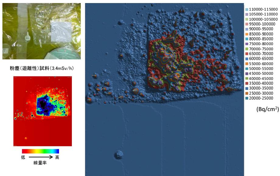
図 140 サンプルの汚染密度分布 (2号機3階④床 ネル布)
