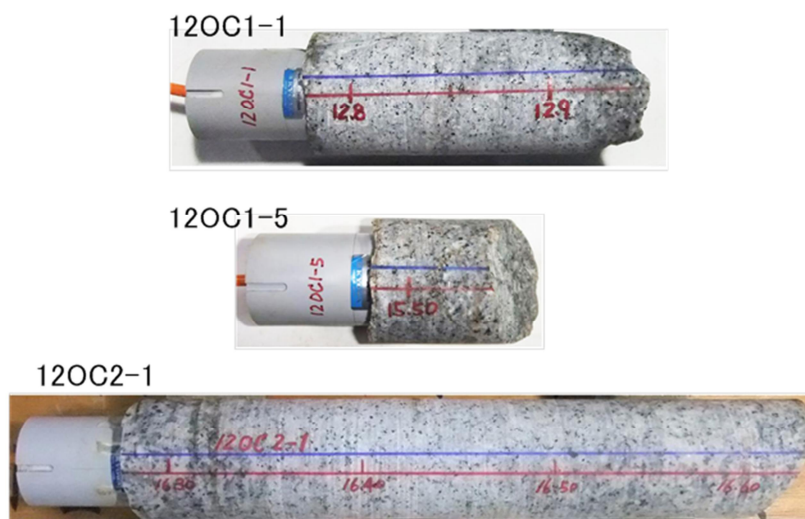
図 5.10.4 二軸ひずみ感度試験で使用了供試体
