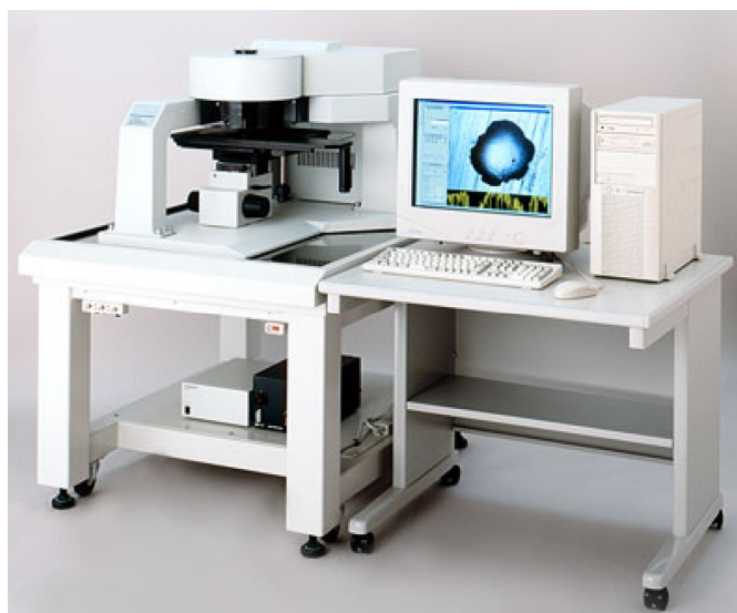
図 2.14 走査型レーザー共焦点顕微鏡(Olympus 製 OLS1100)
