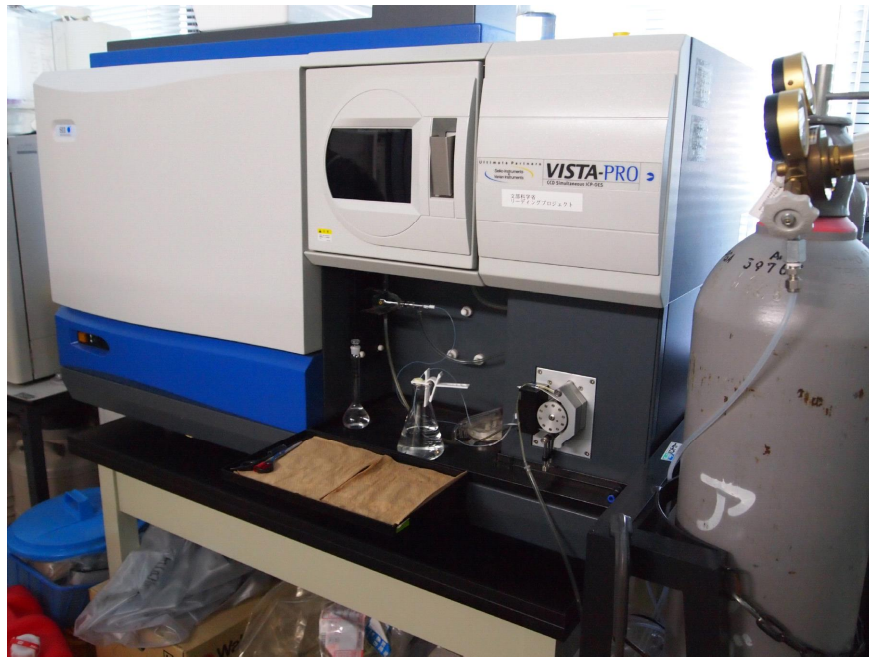
図 2.13 ICP-AES 装置 (SII Vista-PRO)
