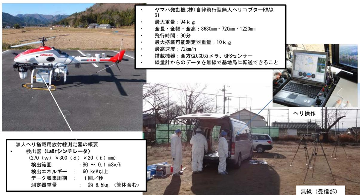
Fig. 3-1 無人ヘリ放射線モニタリングシステム
