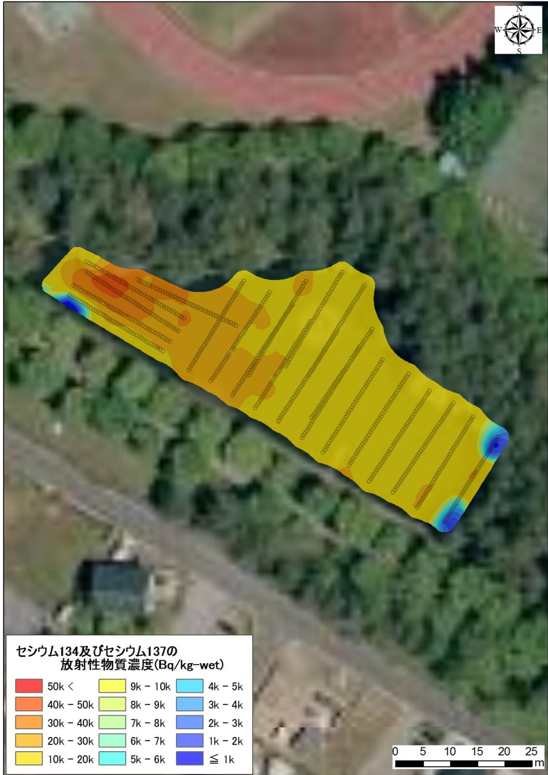
Fig. 8-6 福島大学第3調整池における水底の放射性セシウム濃度マップ
