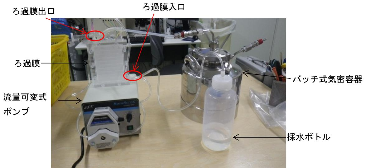
写真 5-1 バッチ式気密容器を用いたクロスフローろ過システムの外観
