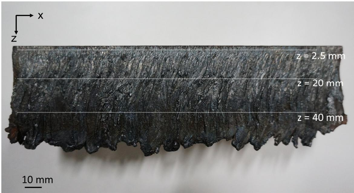
図 15 実験に用いた溶断試験片
