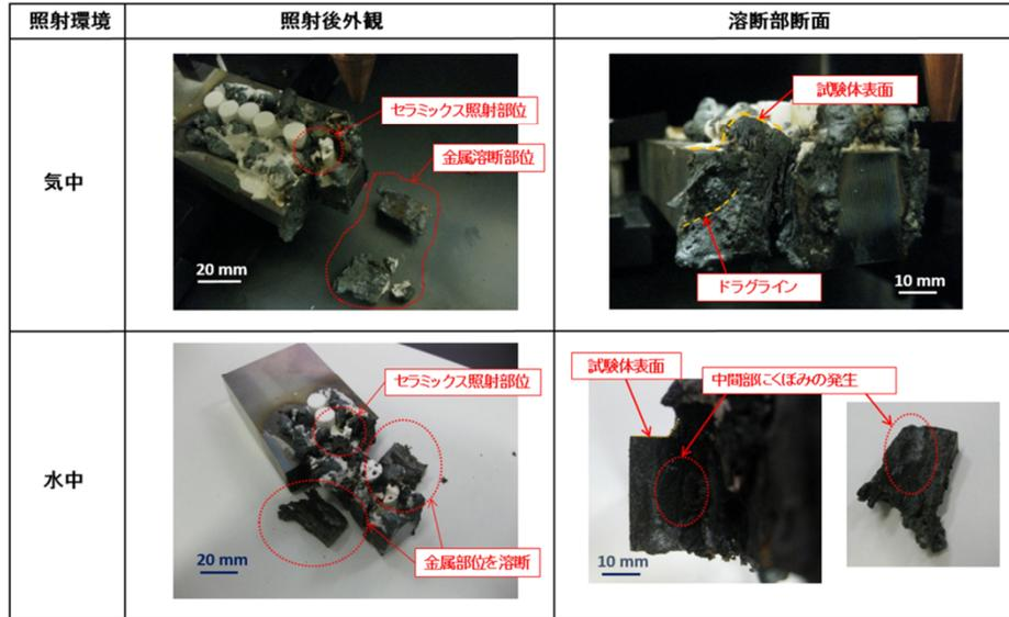
図 43 照射後の試験体外観
