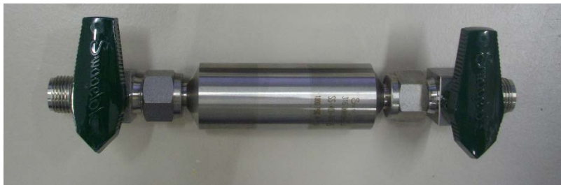
図 3.3.4-1 耐圧サンプリング容器(ダブルエンドボトル)とプラグバルブ
