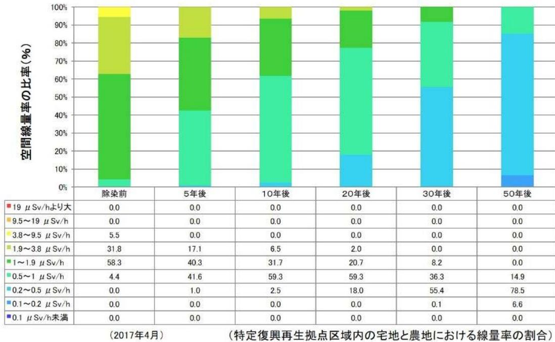
Fig.5.30 大熊町の除染をしない場合の宅地と農地における線量率の推移
