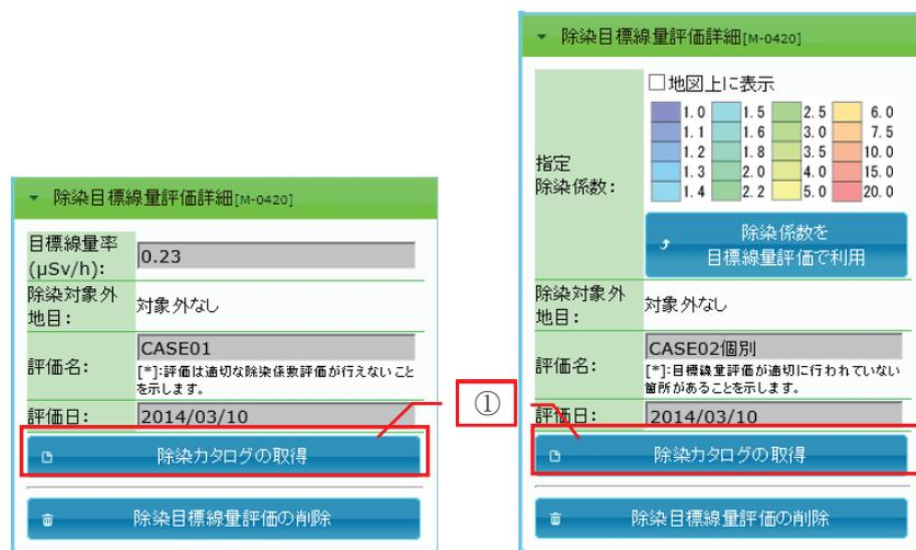
図 14-5 除染カタログの取得（左：目標線量率指定、右：除染係数指定）
