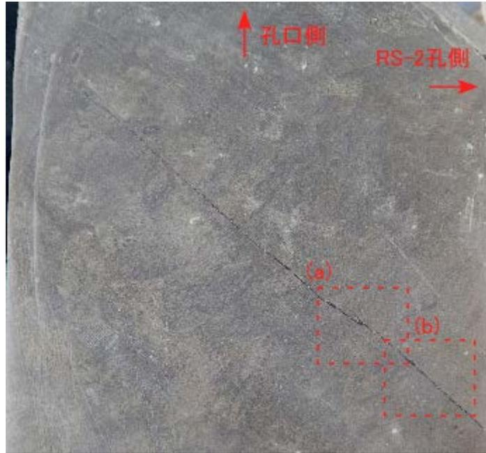
図 3.23 割れ目 RS2-1-2 全体写真（可視光で撮影、上半断面の観察結果）
