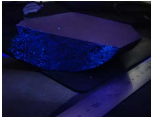
図 3.31 割れ目 RS2-2-4 への樹脂の浸透状況
