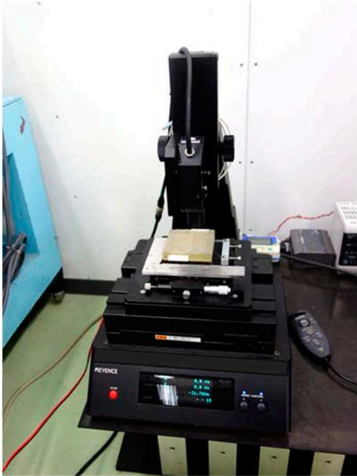
(a) 亀裂表面形状測定装置外観
