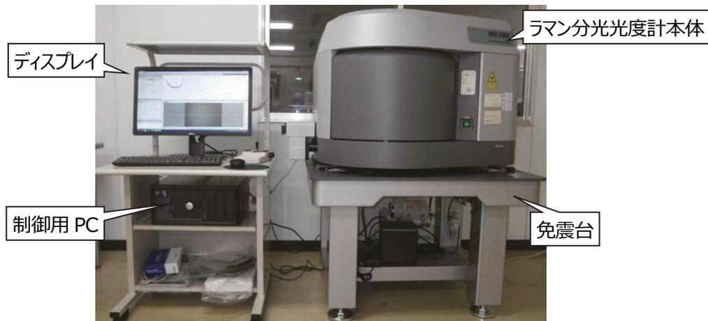
写真 3-1 本研究に用いた顕微レーザーラマン分光光度計
