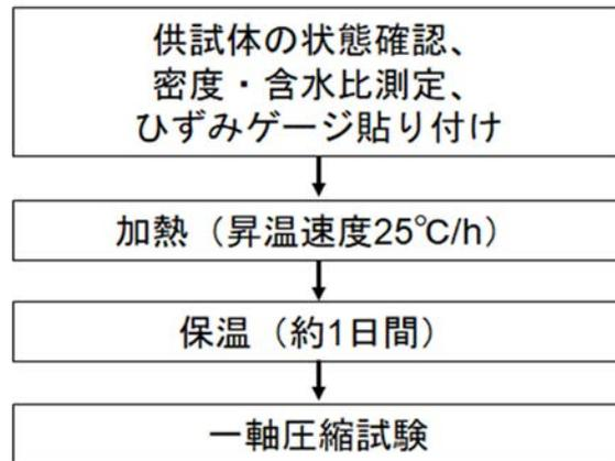
図 2.11 乾燥状態の供試体の加熱方法
