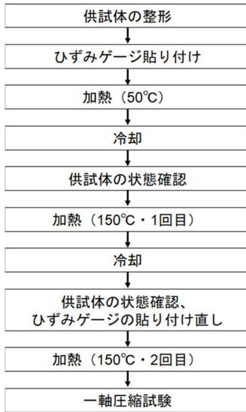
図 2.7 加熱乾燥を考慮した温度・ひずみ測定方法に関する予備検討の実施手順
