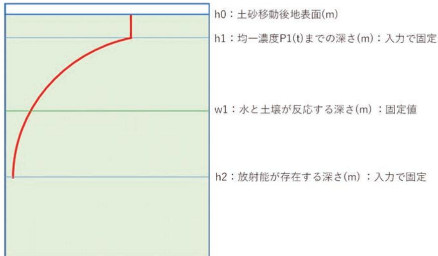
Fig. 23 土砂移動が生じた場合（流出）
