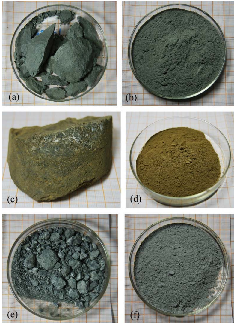
図 3.10-3 摩擦試験に使用したボーリングコア試料（左）と ガウジ（右）の写真（グラフ用紙の太い目盛りは 1 cm） (a), (b) : 塩ノ平地点 SSH-1 孔, 5.96~6.00 m, (c), (d) : 別当地点 SBT-1 孔, 12.82~12.87 m, (e), (f) : 水上北地点 KMK-2 孔, 20.92 m.
