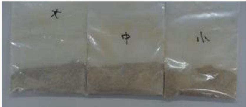
写真 B.7 粉碎した川砂利試料
