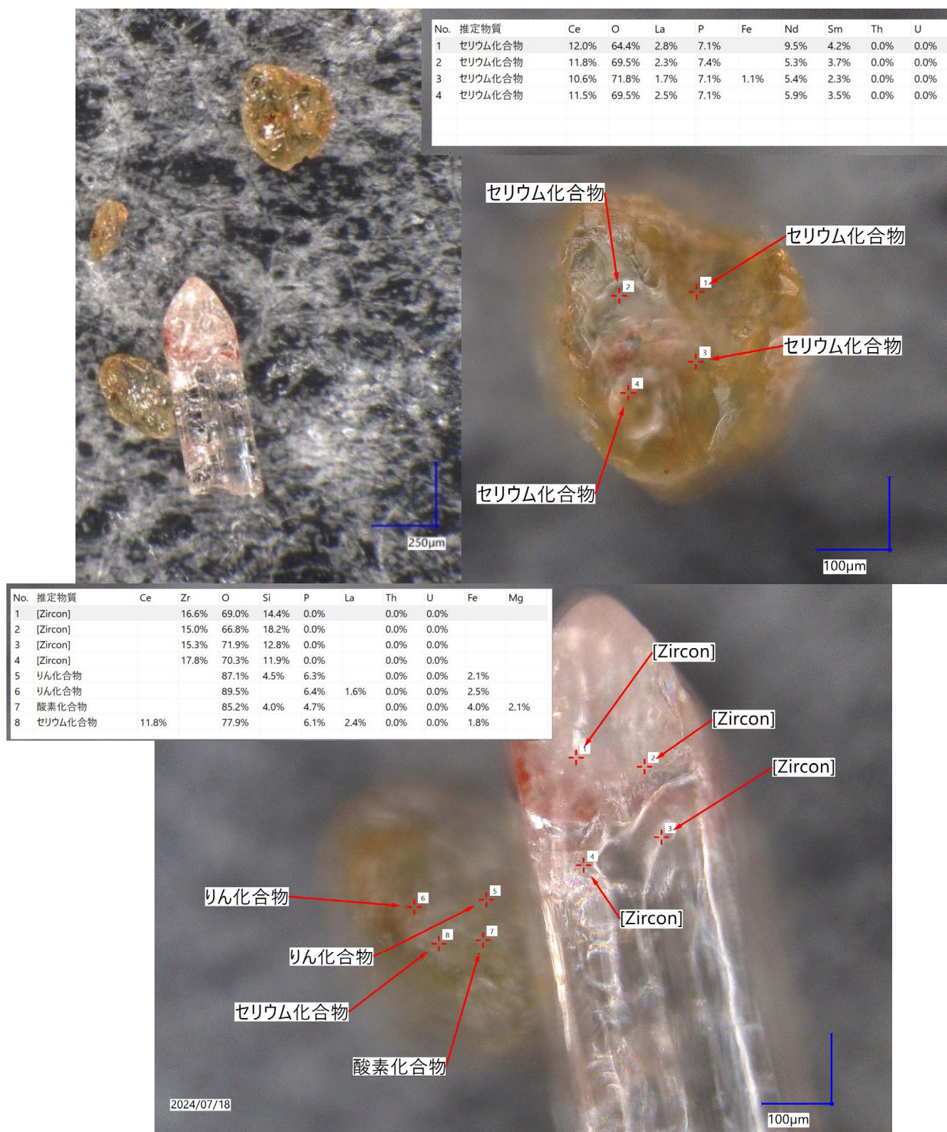
図 2.3.3-3 南極試料 (ARP04) の顕微鏡写真 (左上) と LIBS 分析結果 (右上, 下)
