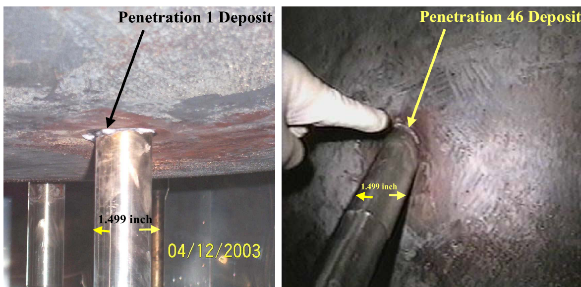
図4.2 BMIノズルNo.1、46におけるホウ酸析出状況
