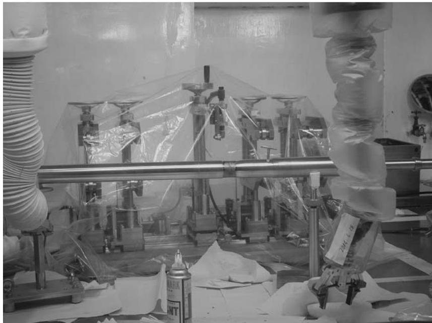
(a) セル内遠隔作業風景（浸透液を塗布した状態）
