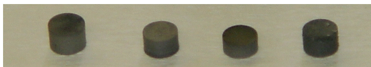
図 1 Pd 添加 \text{PuO}_2\text{-Mo} ターゲット焼結体外観
