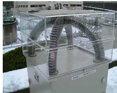
図1 放射線飛来方向測定システム検出部 (右) と RI 線源 (Cs-137) を用いた方向特性結果
