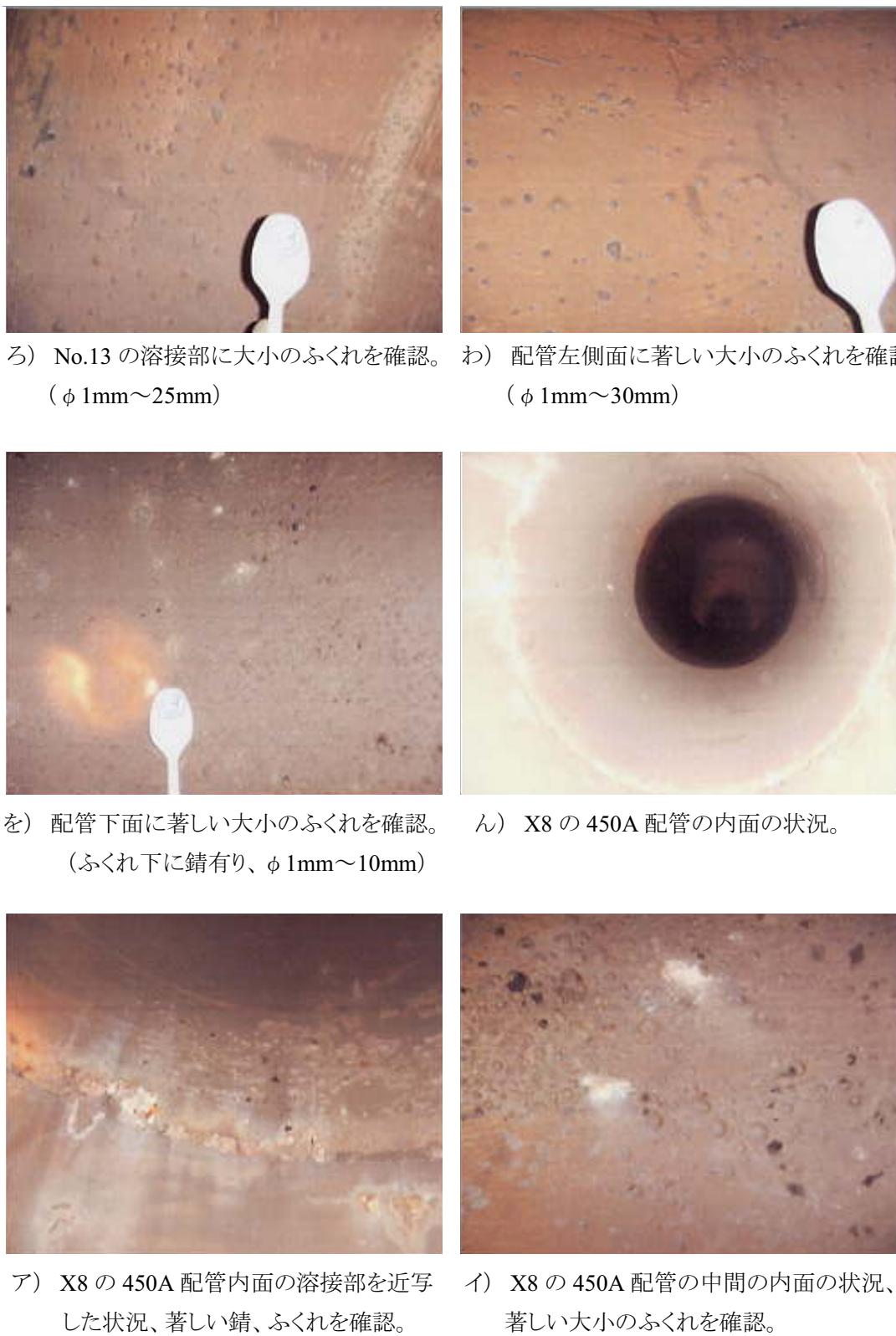
Fig. 7 トレンチ 2 配管（給水配管）内部撮影画像 (8/11)
