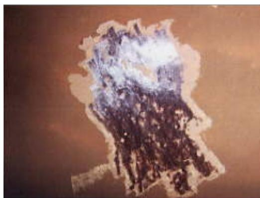
ウ) 配管側面にフクレクラックは確認されず。 エ) X9 の 450A 配管付近に著しいふくれを確認。
