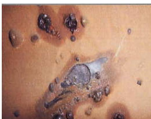
へ) 配管下面に水を含んだ大小のふくれを確認。( $\phi$  1mm~30mm)
