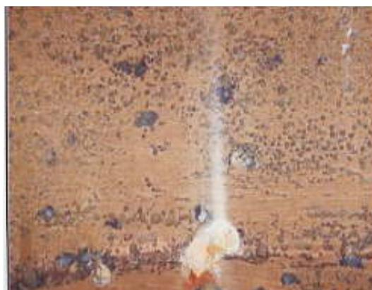
②7 大小のふくれが著しく発錆しているのを確認。( $\phi$  1mm～30mm)
