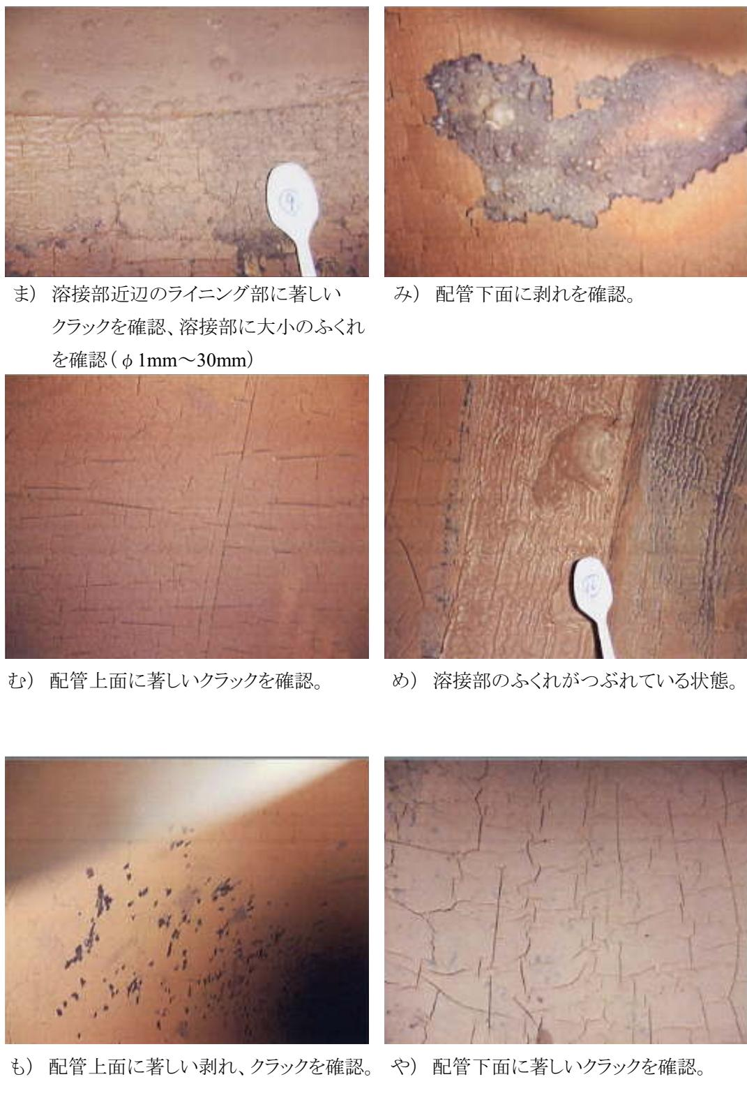
Fig. 7 トレンチ 2 配管（給水配管）内部撮影画像（6/11）
