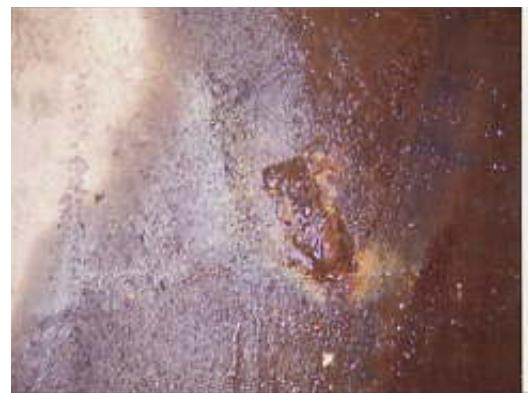
32) 配管下面に錆コブを確認。
