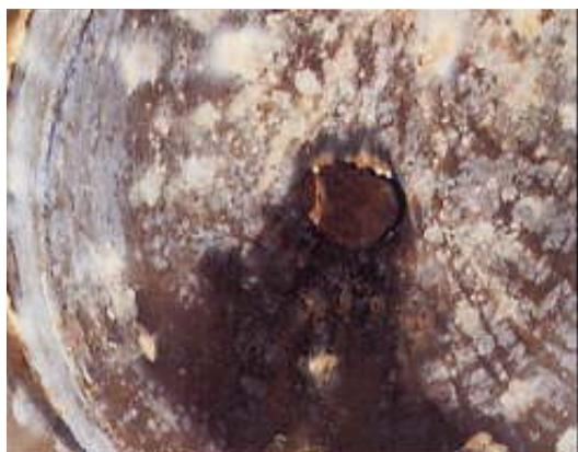
③4 配管内最下部を近写した状況、著しい錆、ふくれを確認。(φ 1mm~25mm)
