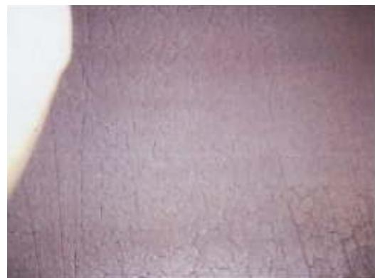
タ) 配管右側面に著しいクラックを確認。
