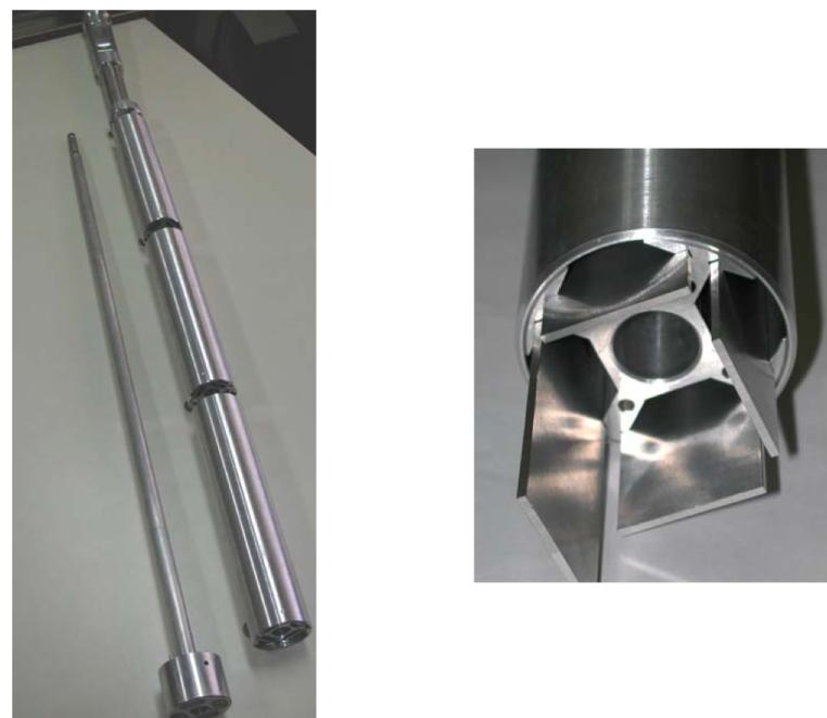
Fig. 2-4  $^{99}\text{Mo}$  製造用キャプセルの写真
