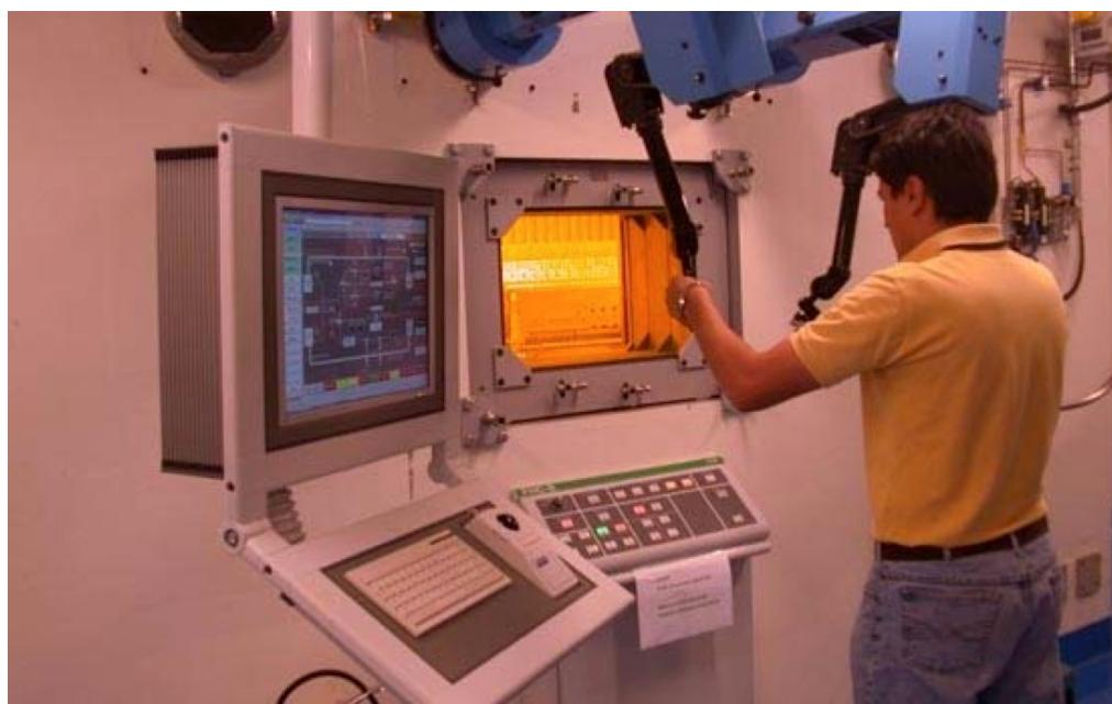
Fig. 5-4 装荷ホットセルの写真
