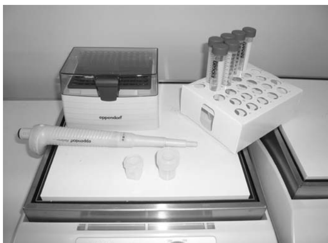
使用機材（前列左より）3cc と 7cc のねじこみ蓋付きテフロン容器、（後列）エッペンドルフ製精密シリンジとチップ、15cc 遠沈管。
