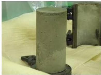
(3) 一軸圧縮強度測定用の供試体
