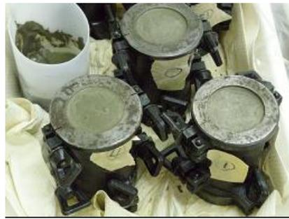
(2) 供試体作製 (型枠への流し込み)
