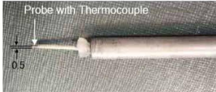
図 2(c) アルミナチューブ絶縁プローブ
