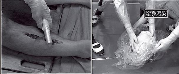
サーベイメータによる直接測定 血液、ガーゼ等の試料の採取
