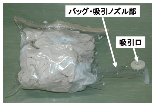
Photo. 6.2.2 真空圧縮状態のバッグ内廃棄物
