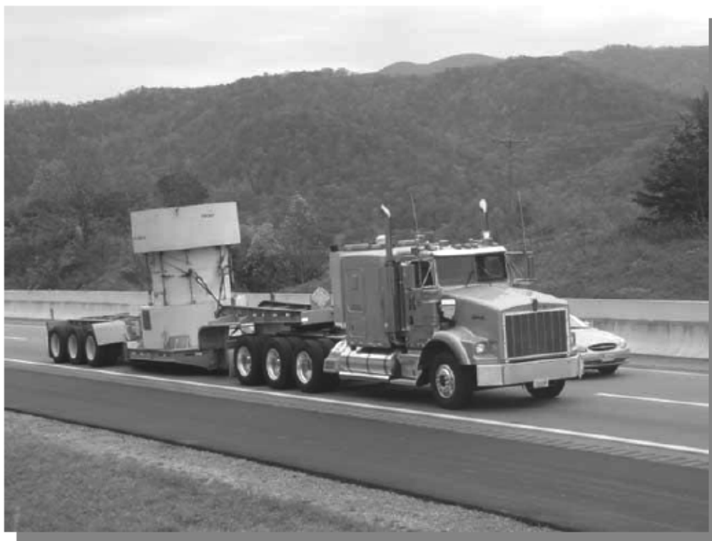
Fig. 3 使用済みイオン交換樹脂の米国内の陸上輸送
