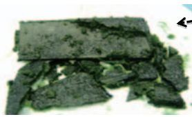
SUS316L HCl腐食表面生成物
