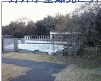
水中爆発用水槽直径8m、深さ5m
