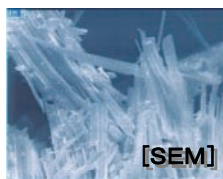
90°C-HClミスト 336h暴露後
