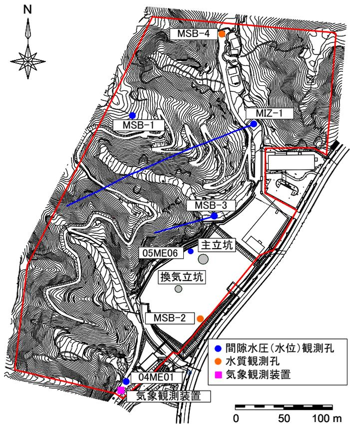
図 4.3-9 研究所用地における地下水モニタリング孔位置図
