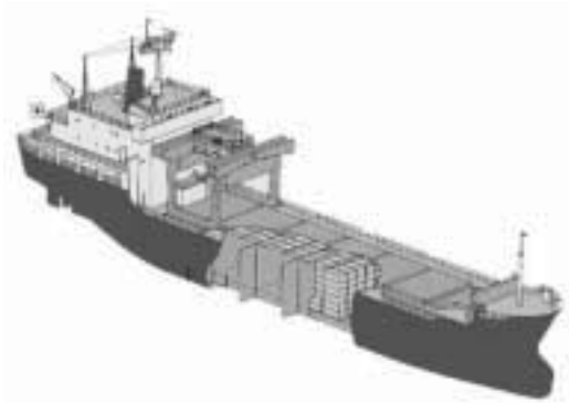
図 8 低レベル放射性廃棄物輸送の専用船（青栄丸）での積載例
