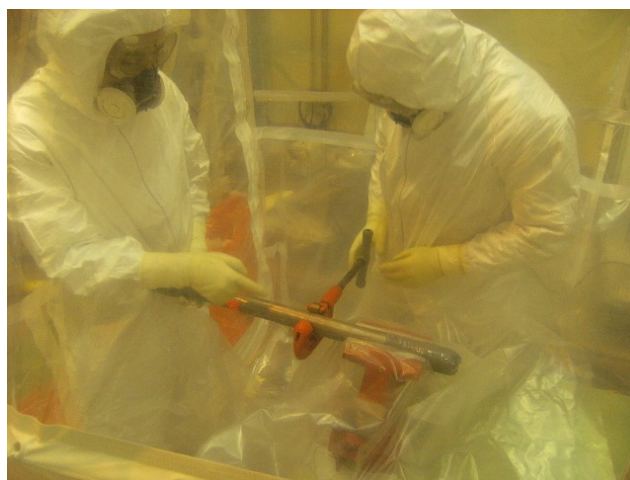
クリアランス検認システム開発に供する金属廃棄物からの試料採取
