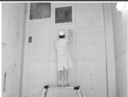
汚染検査 (排気設備室)
