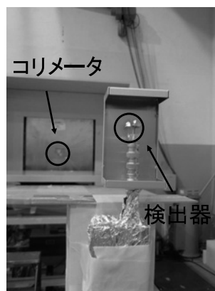
実験体系の写真(実際の測定では検出器は電磁シールド中)
