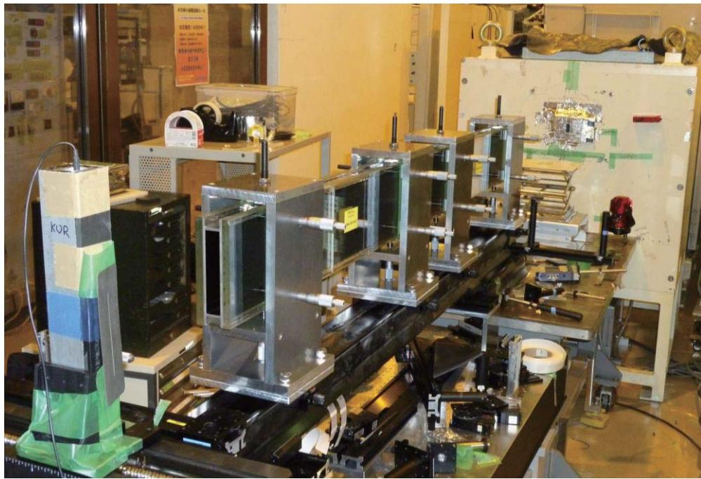
第 4.2.2 図 輸送効率測定のための実験における実際の配置。中央に中性子鏡管ユニットが 2 台並べられている。写真右上のアルミテープで囲まれているのが中性子の入射口、写真左下の白い筒の中に検出器が入っている。
