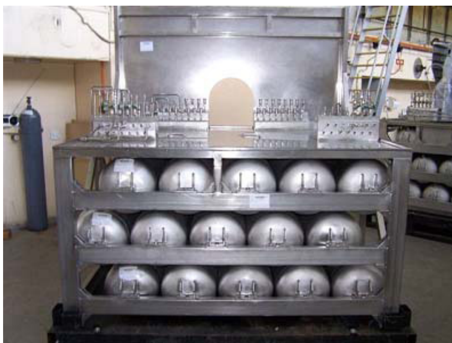
Fig. 5-5 タンクを載荷したラック
