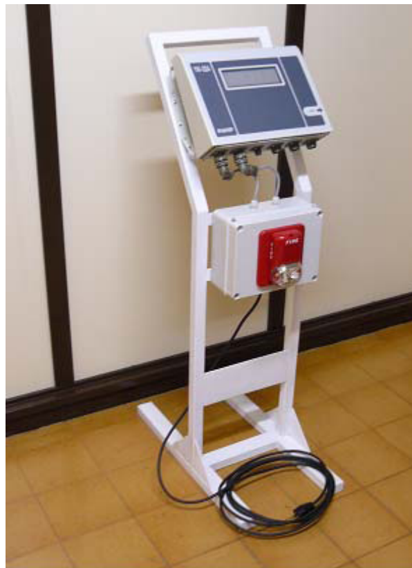
Fig. 5-8 エリアモニタ検出器
