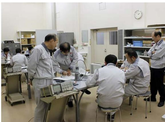
$\beta$ 、 $\gamma$ 、中性子線の線量測定（放射線防護基礎コース）
