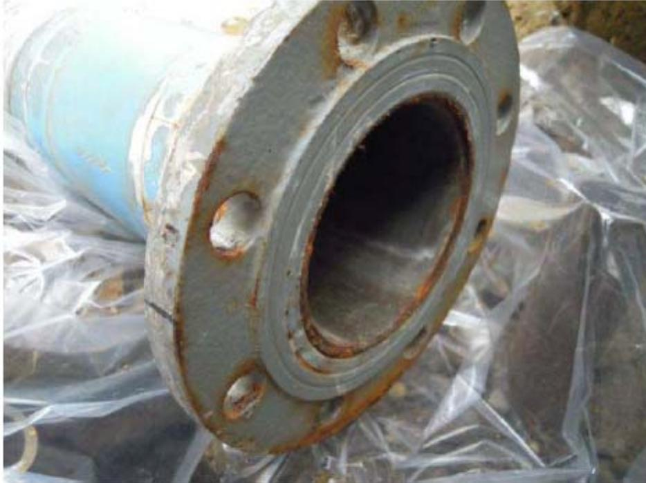
Fig.7 鋼製フランジ(小平面座)
