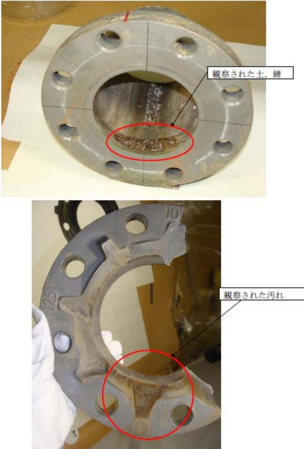
Fig.11 フランジ切断後に観察された内面及びき裂面の状態
