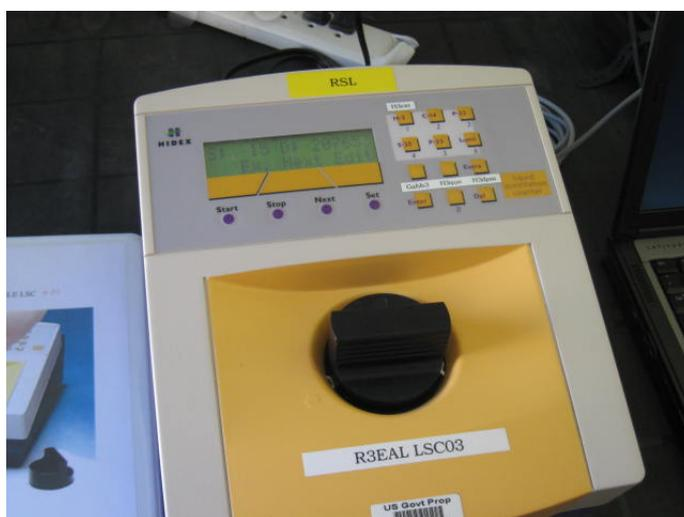
写真 4.12 可搬型液体シンチレーションサーベイメータ
