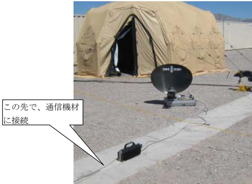
写真 5.1 収納運搬型の ECN 機材 (衛星アンテナ)
