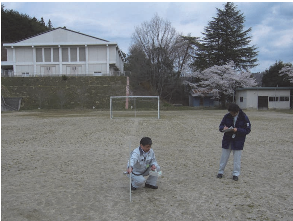
写真 3.3-9 学校モニタリング(福島県内の学校等における校庭等の空間線量率の測定) (2011.4.21 13:52 撮影)
