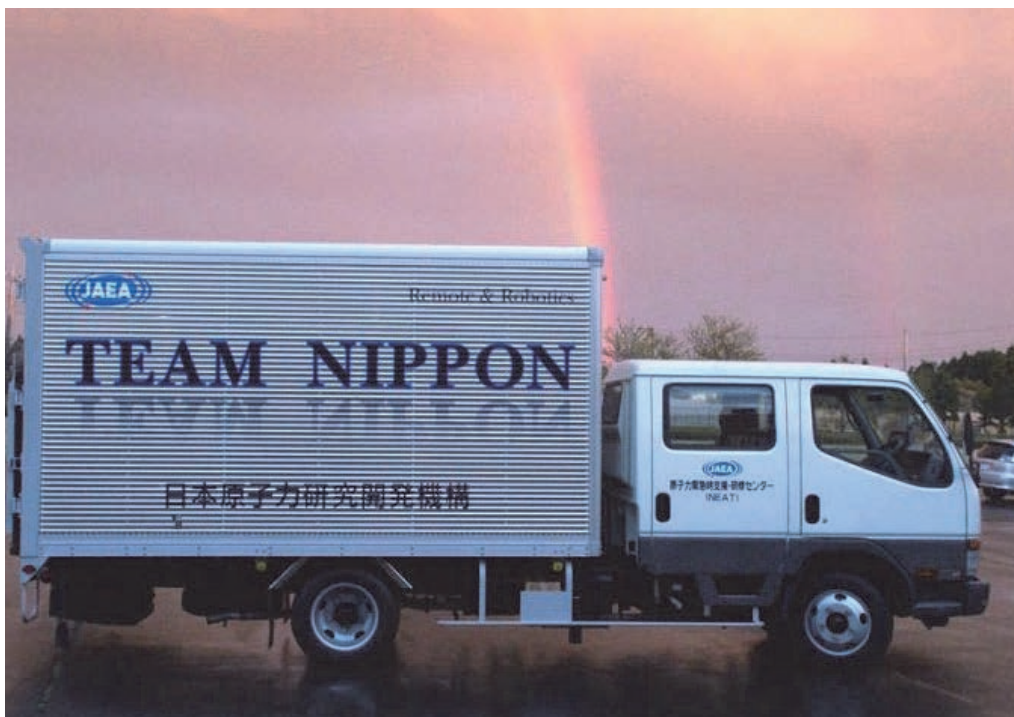
写真 3.3-12 ロボットによる各種作業を支援するロボット操作車(資機材運搬車改良) (2011.4.28 18:20 撮影)
