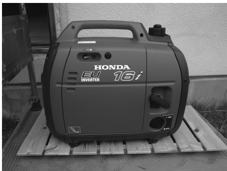
第6.3.1図 可搬型発電機
