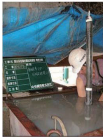
孔口の水槽における コアの回収、チューブ への収納
