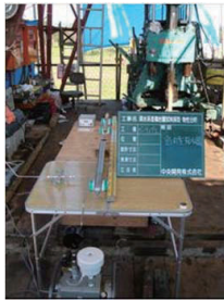
密閉型採水器による 地下水試料の採取
