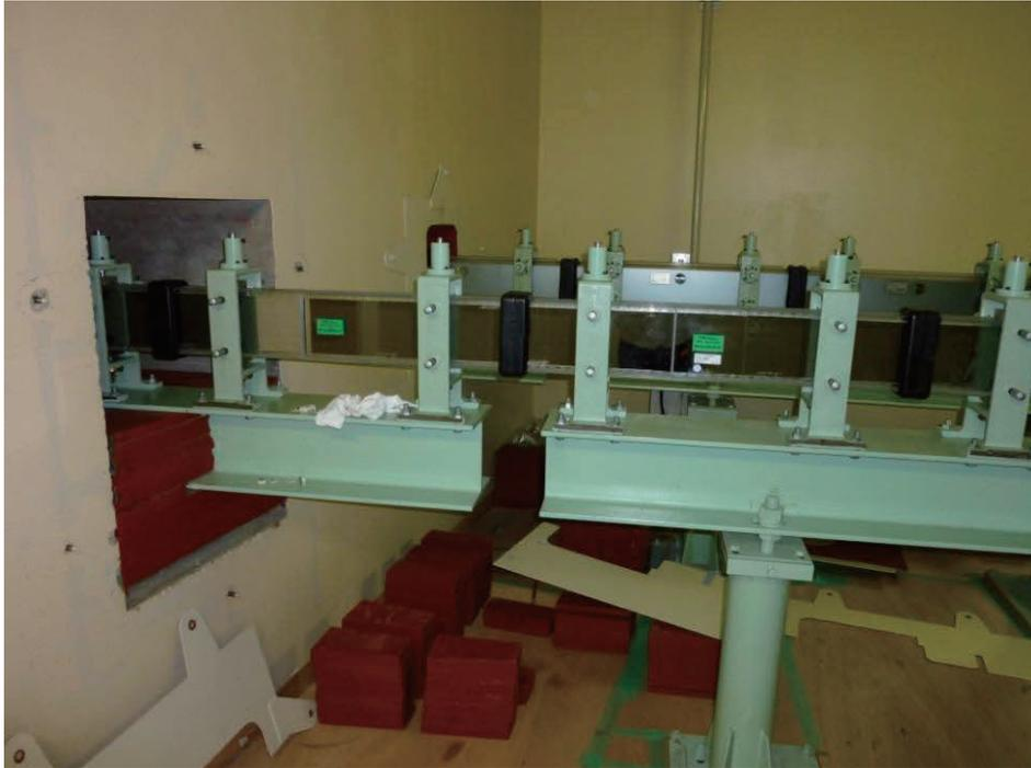
第 5.2.5 図 新規製作した高性能中性子鏡管ユニット(ビームホール内導管室)
