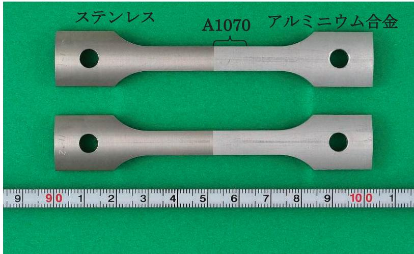
第 5.1.1 図 引張強度試験用試験片の外観
