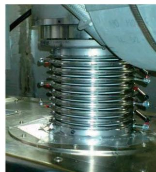
第2.4.8図 9ギャップ加速管（BM EC-1上部）
