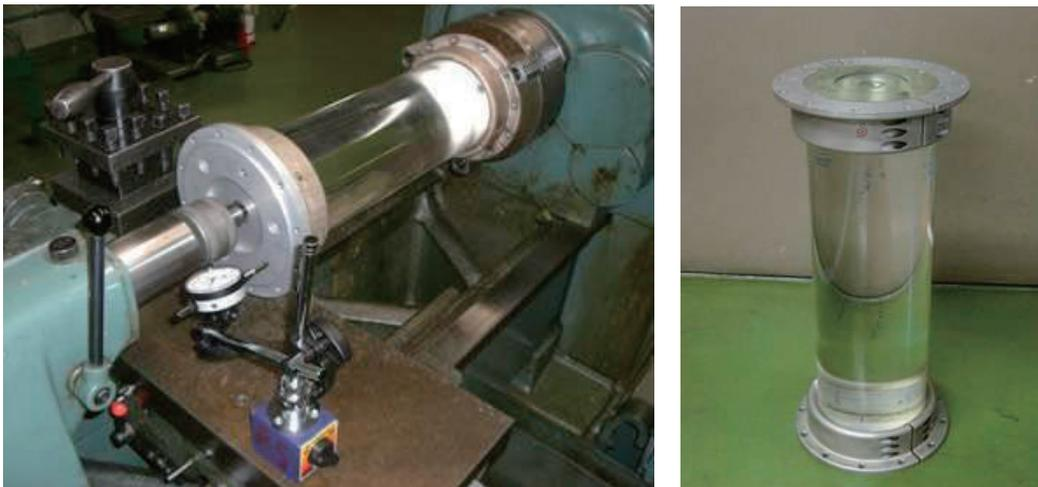
第 3.4.1 図 アクリルシャフトフランジ面の傾き調整作業の様子と取り外したアクリルシャフトの写真
