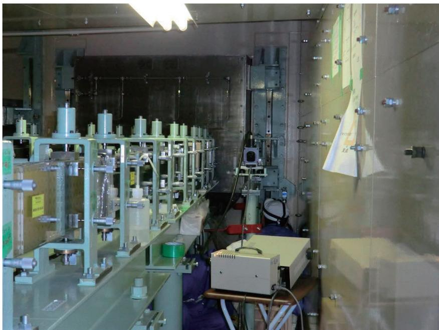
第 5.2.4 図 新規製作した高性能中性子鏡管ユニットの据付(炉室内導管室)
