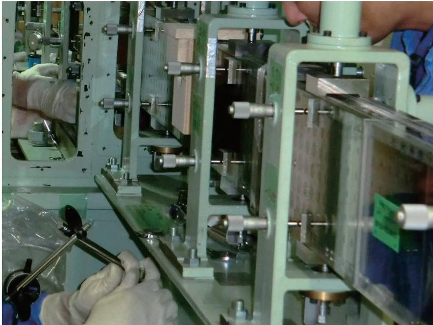
第 5.2.3 図 新規製作した高性能中性子鏡管ユニット(C3 冷中性子導管)
