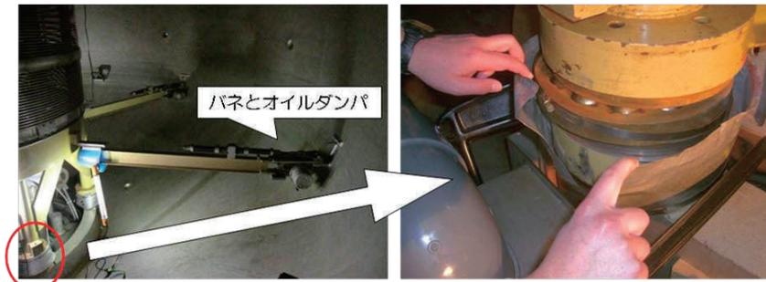
第 2.4.6 図 タンデム加速器の免震機構。絶縁カラムはベアリングの上に設置されバネとオイルダンパーを備えた横からの支柱で揺れを抑える。右写真は地震により中心からずれたベアリング。
