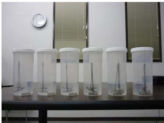
写真 1.1 浸出試験中のカドミウム
